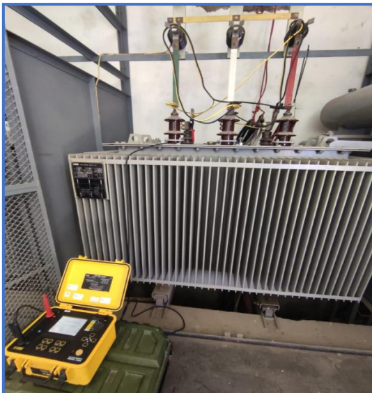
Pruebas de aislamiento de bobinas
