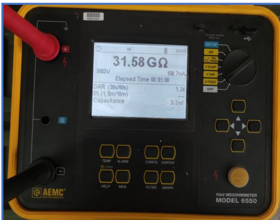
Pruebas de aislamiento de bobinas
